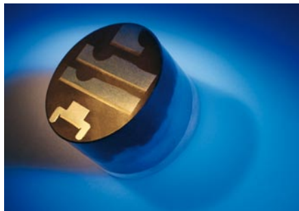
Coupe métallographique transversale et longitudinale pour contrôler la trempe par laser.
