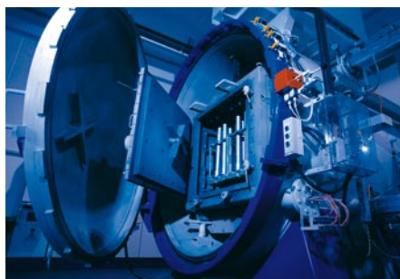
Installation de trempe sous vide avec refroidissement sous gaz pressurisé.
