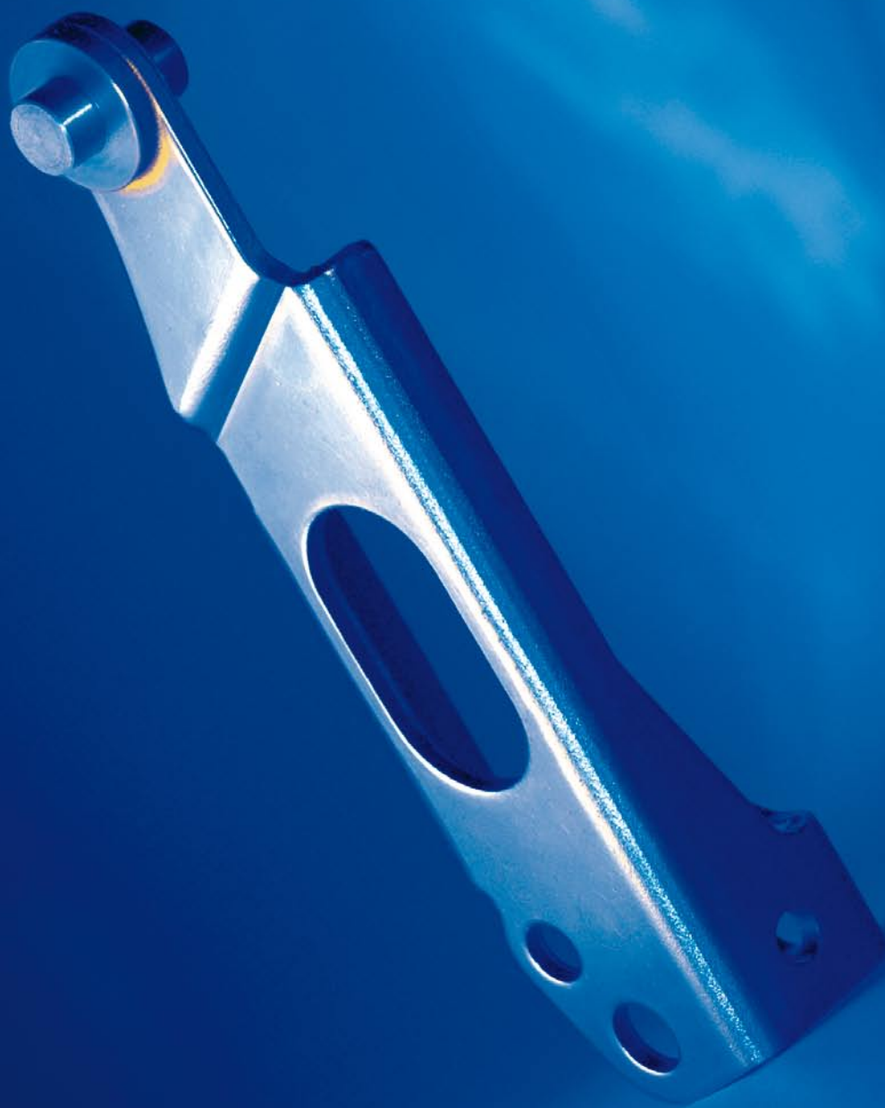
Levier avec boulon brasé. Les deux pièces ont été assemblées avec du cuivre sous gaz de protection et soumises ensuite ensemble à un procédé de cémentation-trempe.
