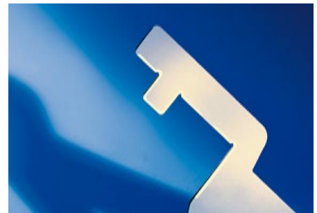
Trempe par impulsion d'une plaque de 0,15 mm d'épaisseur, matière Ck75, trempe dans la zone d'impulsion (en blanc) 870 HV1.
